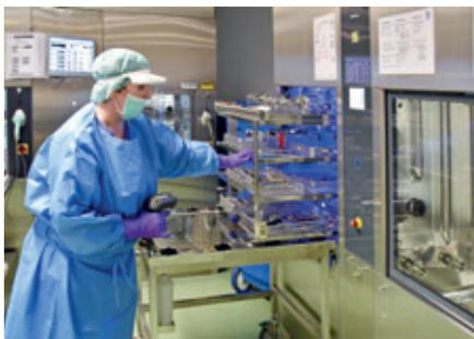
Ausgebreitet auf Siebe werden die benutzten Geräte in die Reinigungsmaschinen geschoben.
