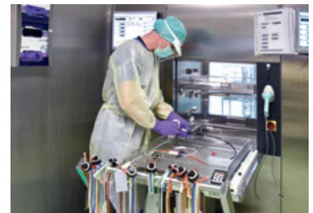
Hitzeempfindliche Geräte, die sogenannten „Kritisch-C-Produkte“ wie zum Beispiel Endoskope, werden in speziellen Waschmaschinen bei maximal 60 Grad Celsius gereinigt und dann desinfiziert.
